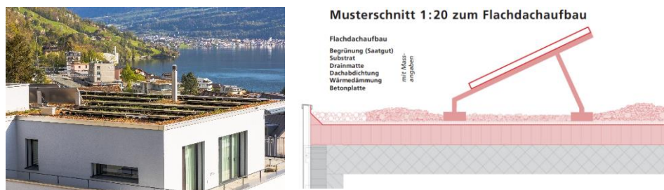
Abb. 49: Beispiel Begrünung Dachfläche mit Solaranlage in Walchwil (links), Dachaufbau mit Solaranlage und Begrünung (rechts) (Merkblatt zur extensiven Dachbegrünung Gemeinde Emmen)
